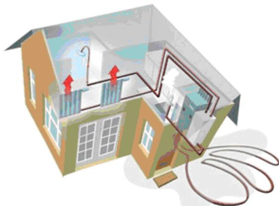
Рисунок: Иллюстрация теплового насоса «грунт с замкнутым контуром, пластовая вода–вода» (Ссылочный документ: *Dansk energi, 2011, Den lille bla om varmepumper. www.danskenergi.dk*)
