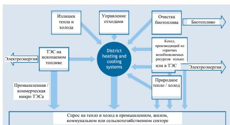
**Рисунок:** Различные ресурсы, используемые в системах централизованного теплоснабжения и холодоснабжения<sup>50</sup>
